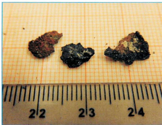
Zdjęcie 6. Wyodrębnione z odpadu paleniskowego (popiołu) nadtopione fragmenty tworzywa sztucznego
